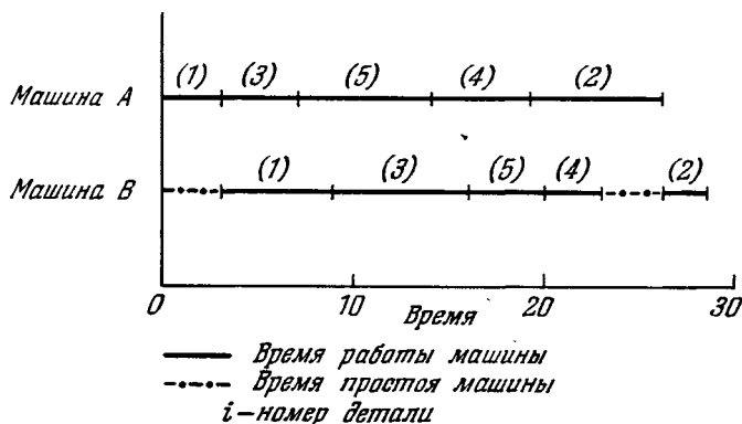
Рис. 16.2. Диаграмма Ганта оптимальной последовательности пяти деталей на двух машинах.
